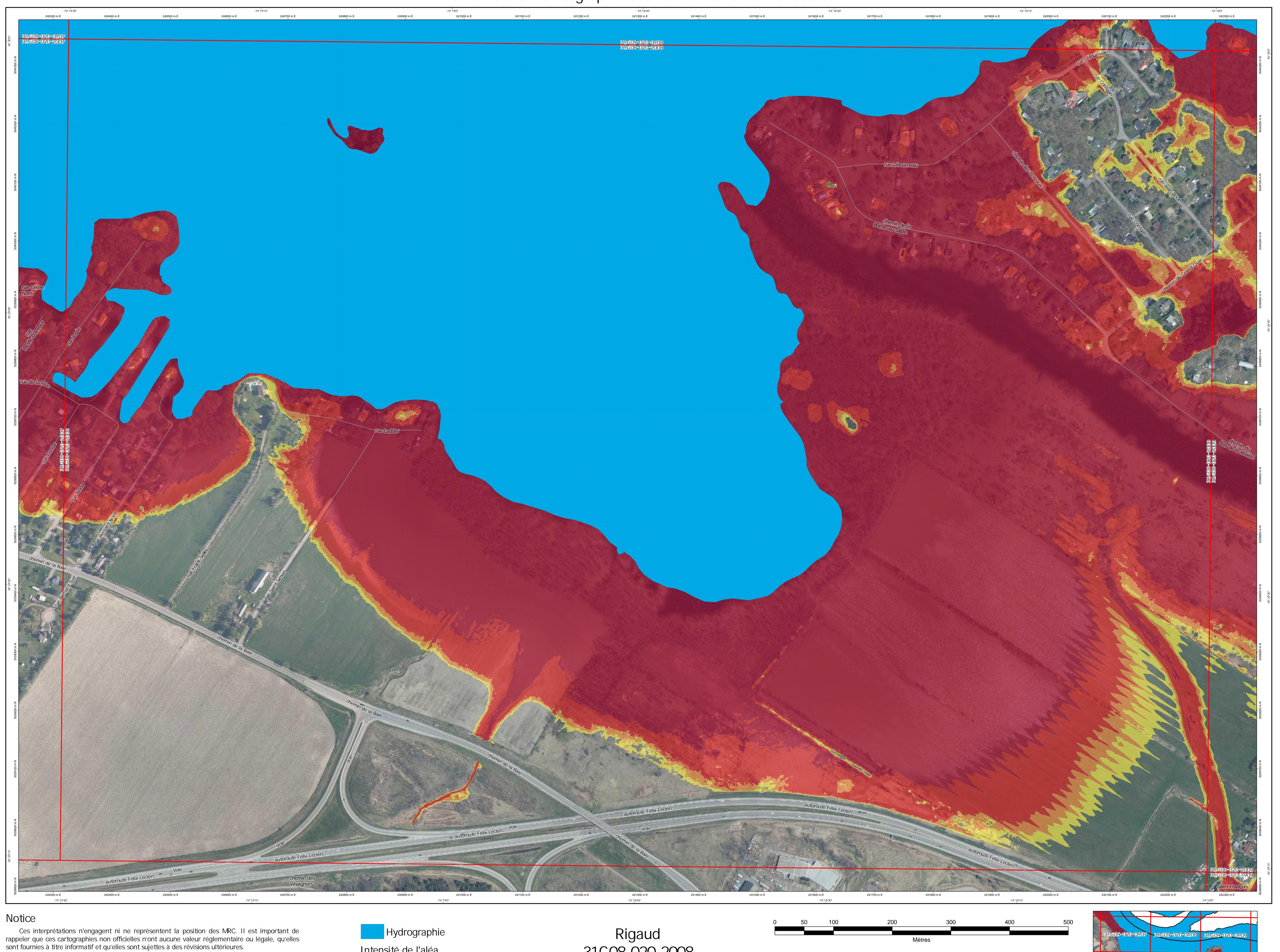
Cette carte représente l'intensité de l'inondation en fonction des zones de récurrence 20 ans, 100 ans et 350 ans et des valeurs de submersion telles qu'inférées des séries statistiques, modèles hydrologiques et modèles de terrain produits par la MRC de Vaudreuil-Soulanges dans le cadre d'un mandat confié à cet effet par le ministère des Affaires municipales et de l'Habitation.
